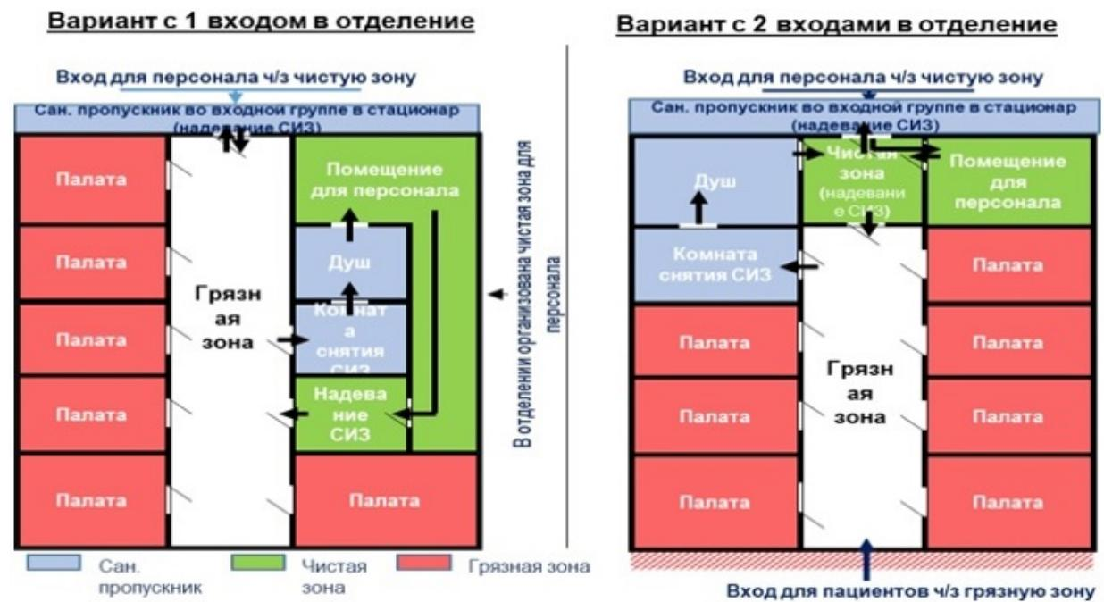
Схема модульного инфекционного стационара
